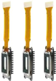
Die digitalen Treiberpanels reduzieren den Bereich zwischen den Pixeln in jedem Bild auf ein Minimum, wobei die roten, grünen und blauen Bereiche ausgerichtet werden, und das mit einer Reaktionszeit von nur 2,5 Millisekunden. Das ist wesentlich schneller und stabiler als ein LCD-Fernseher und erzeugt ruckelfreie, unverpixelte Bilder mit natürlichen, fließenden Bewegungsabläufen.
